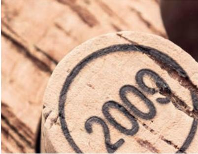
Natürlicher Kork ist ein leichtes, elastisches Material, welches aus der Rinde der Korkeiche geerntet wird. Aus dieser Rinde sind natürliche Korkzapfen von Weinen gemacht.
